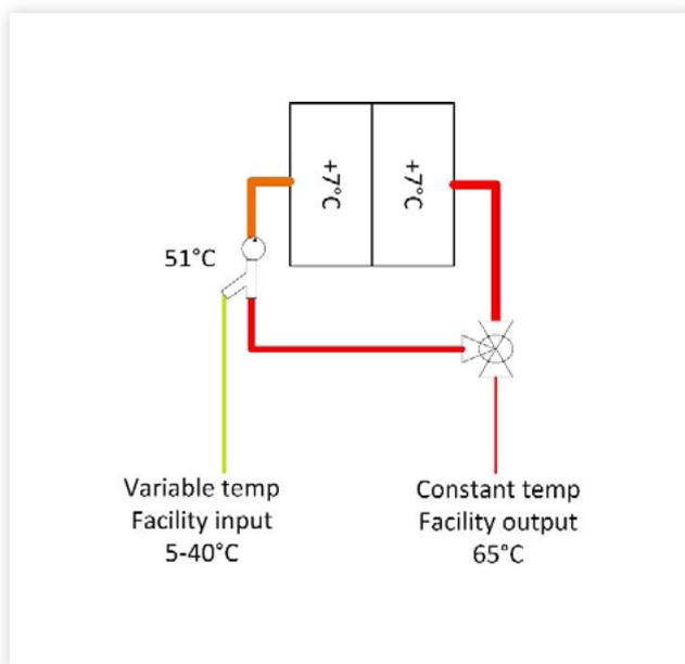
Image 9 Micro datacentre reuse schematic
